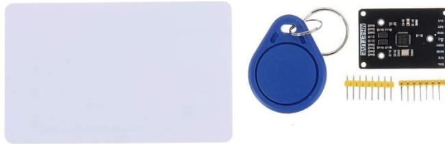
L'RC522 è progettato per creare un campo elettromagnetico a 13,56 MHz con il quale comunica con i tag RFID e supporta la comunicazione sui protocolli SPI, I2C e UART. Nel nostro caso, comunica con Arduino tramite SPI (interfaccia periferica seriale) a 4 pin e una velocità dati massima di 10 Mb/s.
